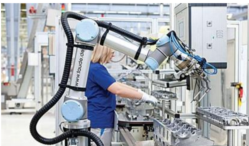
SLIKA 2. Suradnja kobota UR10 i radnika u industriji motora /20/
