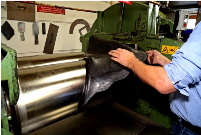
SLIKA 3. Smješavanje kaučukove smjese – oplemenjivanje (izvor: https://www.kraft-gummi.de/unsere-ausstattung/ )
