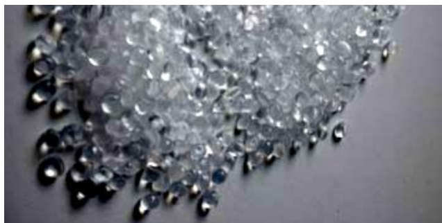
SLIKA 1. Polietilenski granulat kao proizvod proizvodnje materijala (izvor: Wikipedia)
