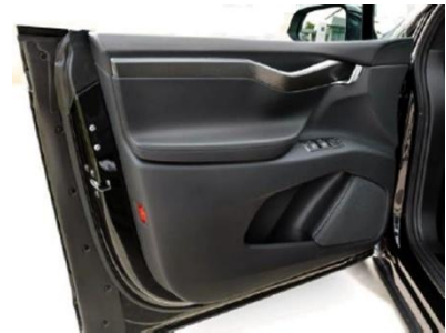
Panel zadnjih vrata na modelu Tesla X (levo); laminiranjem pomoću vakuuma izrađen je unutrašnji deo vrata od polipropilena ojačanog biljnim vlaknima s površinom od TPO filma i podlogom od penastog materijala (desno). Izvor: www.kiefel.com
