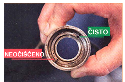
Zaustavni prsten kalupa: levo – neočišćeno; desno – očišćeno
