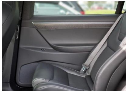
Panel zadnjih vrata na modelu Tesla X (levo); laminiranjem pomoću vakuuma izrađen je unutrašnji deo vrata od polipropilena ojačanog biljnim vlaknima s površinom od TPO filma i podlogom od penastog materijala (desno). Izvor: www.kiefel.com
