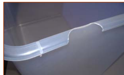
Prikaz nedovoljnog punjenja kalupa usled zarobljenog vazduha
