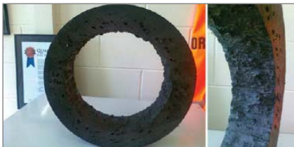
Šupljine i hrapava površina cevi usled zaostale vlage u kompaundu
