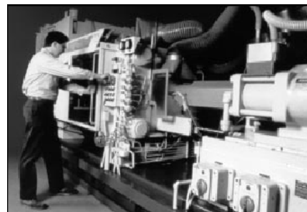
Polikarbonat se može preradivati na konvencionalnim mašinama za injekciono presovanje
